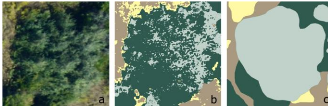
8. ábra Osztályozási hiba 2: egyéb fásszárúak kategóriába sorolt ezüstfa. (a: ortofotó, b: számítógépes osztályozás, c: vizuális interpretáció)
